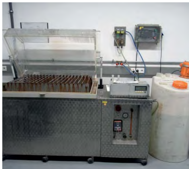
Obrázek 1: Zkoušky v komoře se slanou mlhou
