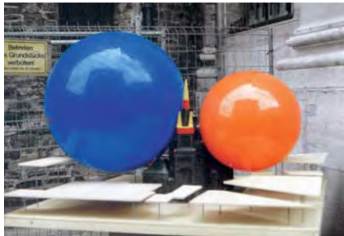
Obrázek 5.1.1.6 Katedrála v Cáchách: Model s okolím a valícími se koulemi třídy ochrany III a II; Zdroj: Prof. Dr. A. Kern, Cáchy
