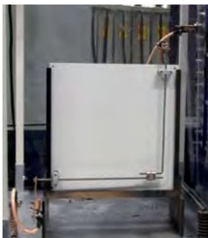
Obrázek 5: Vzorek upevněný na izolační desce (svorka MV) pro test rázovým proudem
