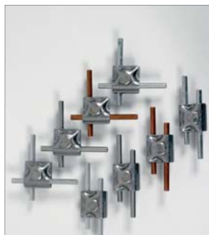
Obrázek 4: Zkušební kombinace svorky MV (paralelní a křížové uspořádání)
