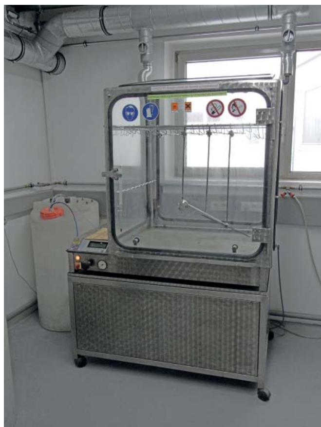
Obrázek 2: Kesternichův test v komoře se sirnatou atmosférou
