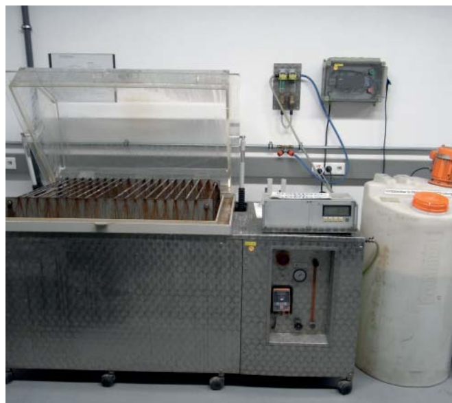
Obrázek 1: Zkoušky v komoře se slanou mlhou
