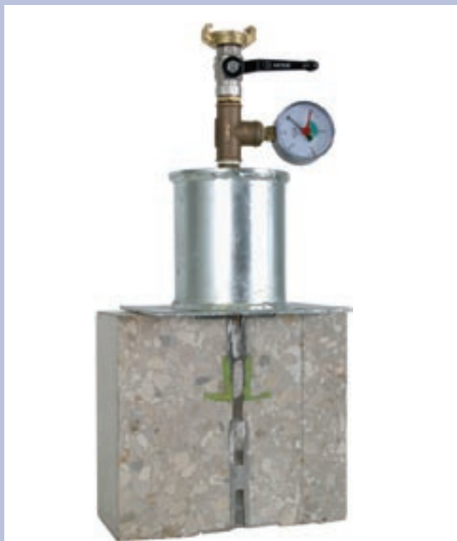
Uspořádání vzorku (řez) pro zkoušku tlakovou vodou
