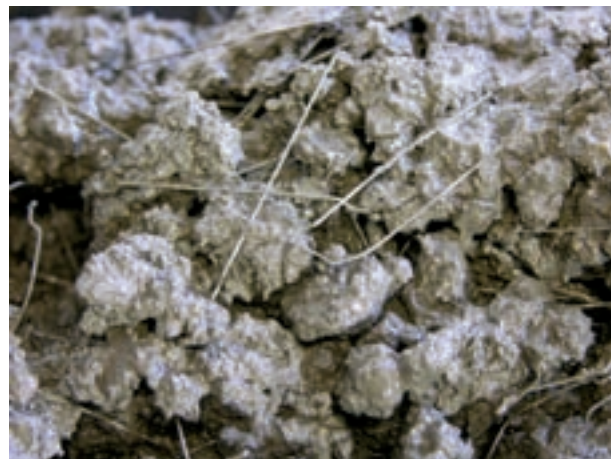
Čerstvý drátkový beton
